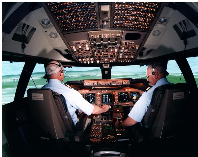
Figura 2.4: Simulador de un Boeing 747 de la NASA
