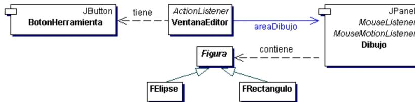
Figura 4.4: Diagrama de clases del diseño inicial del caso de estudio proporcionado por el instructor.
