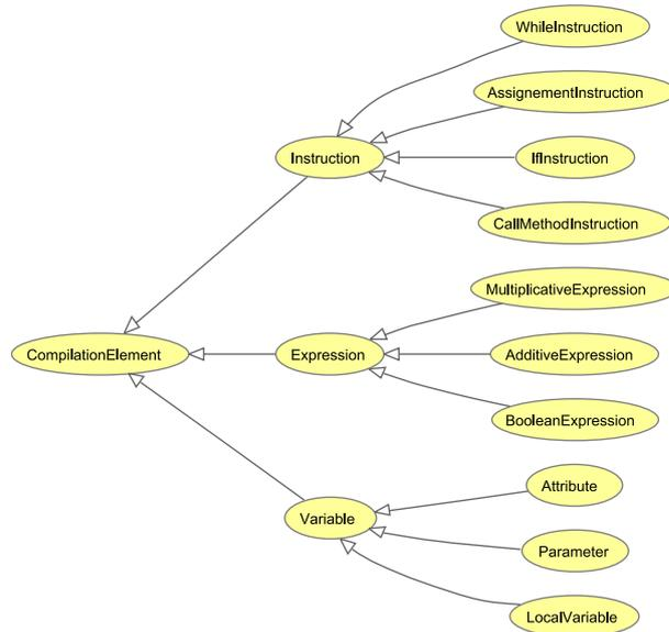
Figura 4.9: Vista parcial de la ontología de elementos de compilación de Java
